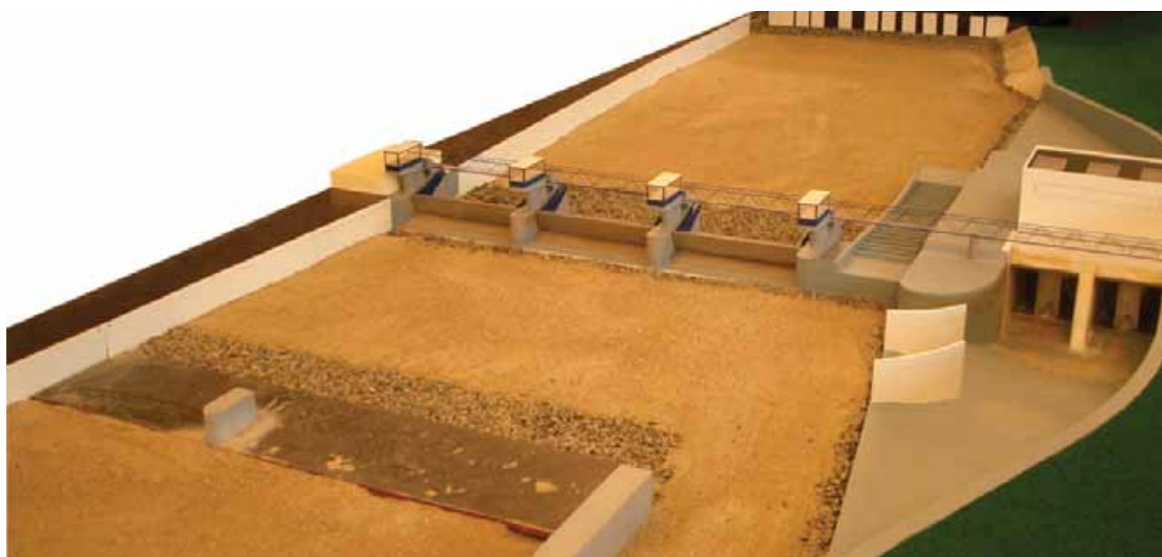
Hydraulický model části koryta Labe v perspektivě leteckého snímku
